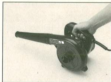
ストレートノズルでブロウ 図7
