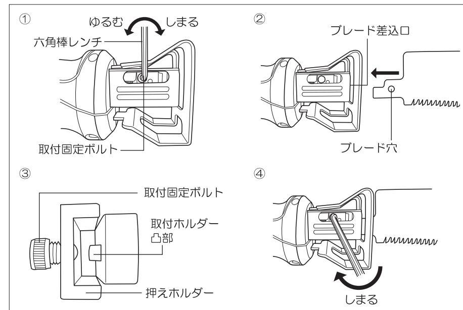
■ジグソーブレード(市販品)取付は、右図のブレード穴に取付ホルダー凸部が入るように取り付けしてください。
